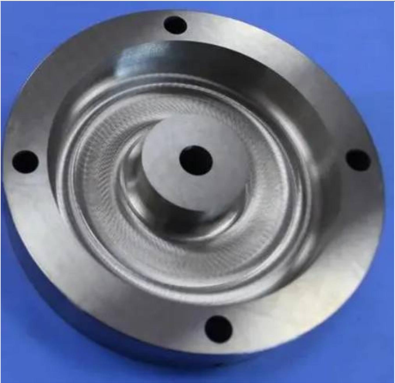
首先，硬质合金模具具有卓越的硬度和刚性。它由钨钢粉末和粘结剂经过高温压制而成，硬度高达65-85HRC以上，相当于钢铁的数倍。这使得模具在长期使用过程中能够承受高强度的冲击和压力，不易变形和磨损，保证了模具的精度和稳定性。即使在高温环境下，硬质合金模具依然能保持较好的机械性能，不会因温度波动而失去使用价值。
