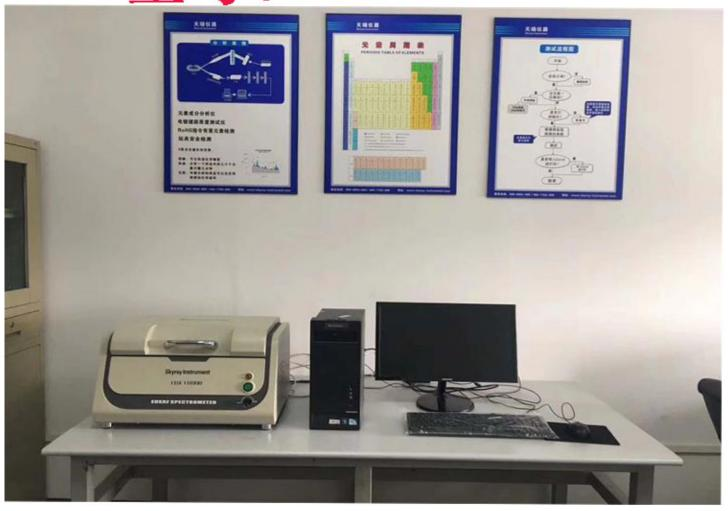
EDX1800B型Rohs检测仪器搭载天瑞仪器新FP分析软件,软件处理的谱形更合理,计算结果更准确,具有的谱图对比功能,随时监督供应商的物料工艺变化,因为供应商的物料环保风险主要发生在原材料和工艺条件变更。
