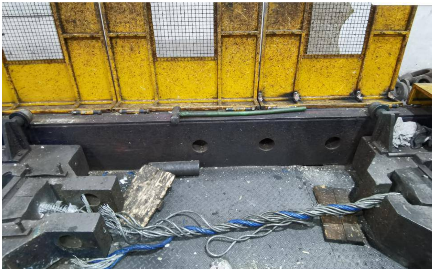
图3.2.2 直径44mm钢丝绳索具拉伸破断试验（钢丝绳破断，索节完整）
