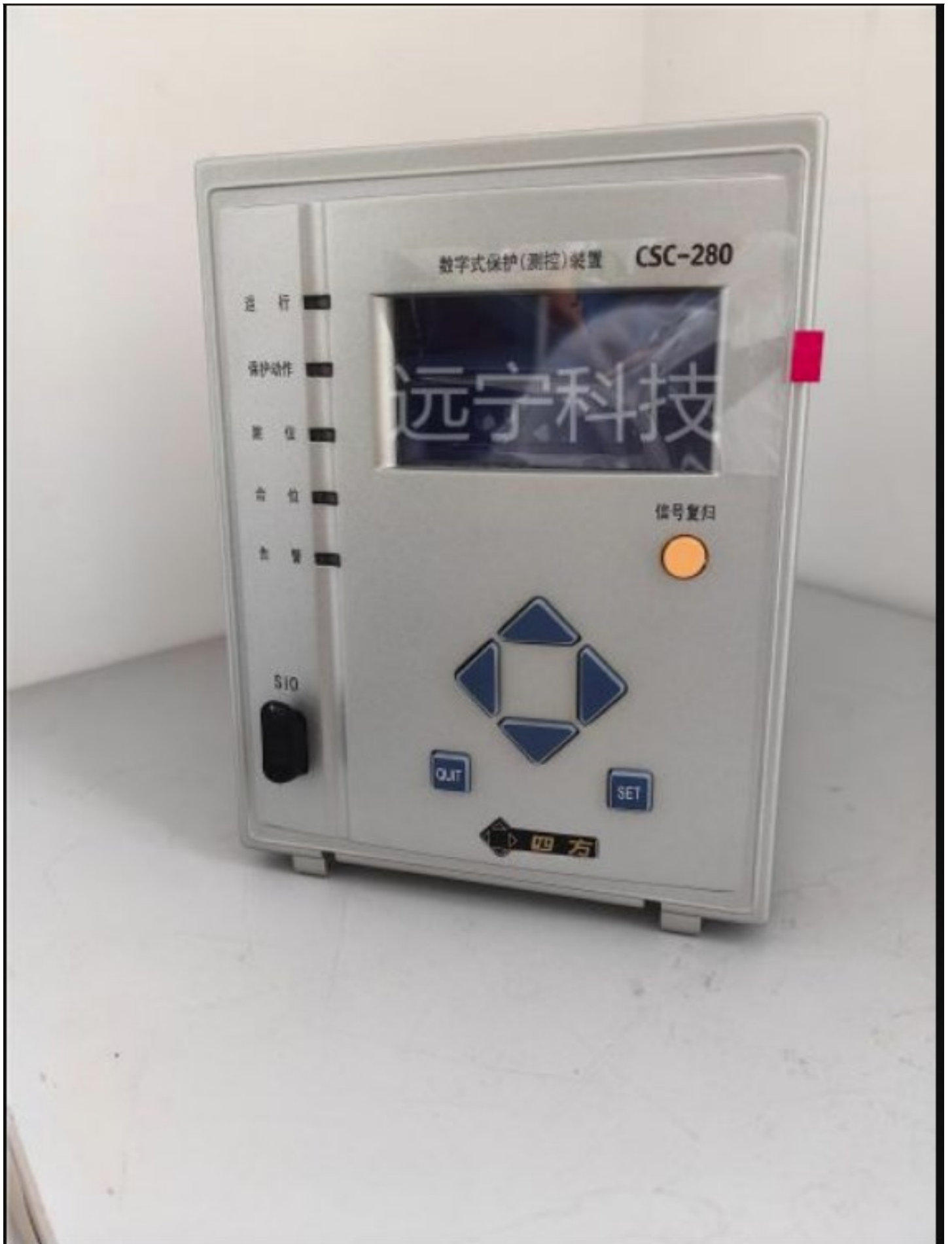
CSC-282S适用于35kV以下变电所所用或发电厂、工矿企业厂用变压器的保护及测控，可在开关柜就地
