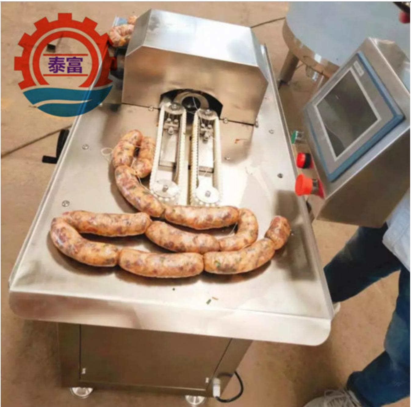
腊肠自动扎线机,全自动双路香肠扎线机,玉米肉肠自动扎线机香肠自动绕线,先将肠通过扎线的圆圈,然后将一头通过控制电脑版的上面的牵引,点动的方式,一点点把肠放进去,通过输送带挤住肠,带动肠前进。后面实现将十几米或是更大的肠分割成一段一段的。
