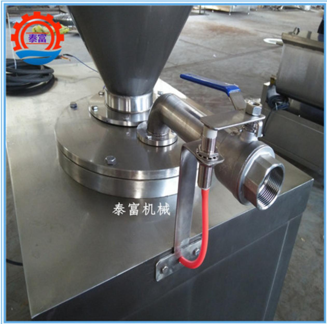
液压灌肠机是加工肠类制品的必备设备。能灌制大、中、小各种规格的肠制品。该产品外形美观、做工精良、操作方便、使用安全可靠。该机的料斗、阀门、灌肠管及整机外包装均采用优质不锈钢制造。符合食品卫生要求。
