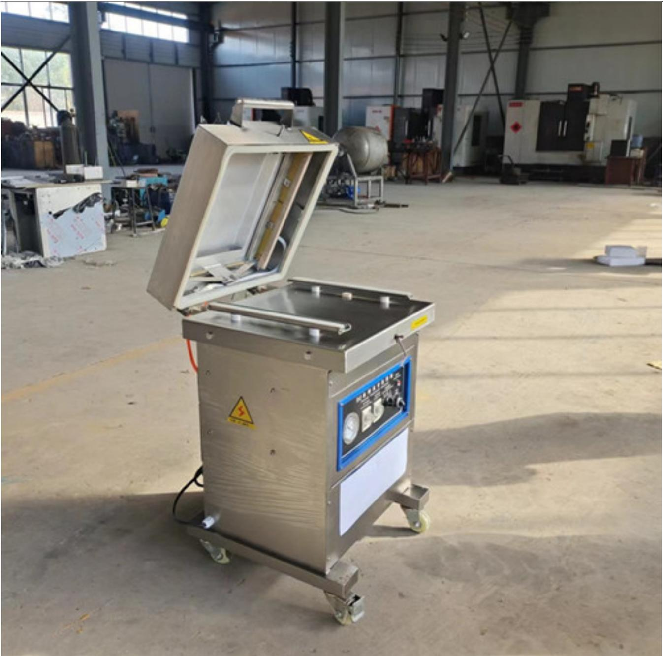
1. 不锈钢机壳表面经过多道特殊工艺处理，均匀、豪华，具有耐脏、耐刮伤等优点。2. 封口温度设有高、中、低三档。3. 封口时间可在0-10s范围内调节。4. 控制面板上设有急停按钮，如发现包装过程有异常，按急停按钮，即可中断包装过程使用安全。5. 使用高品质大功率真空泵，抽真空效果好。6
